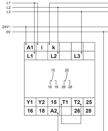
Anschluss 1~ 230V mit Powermodul 230V AC ohne Fehlerspeicher mit Stromwandler  $I_N > 12A$
