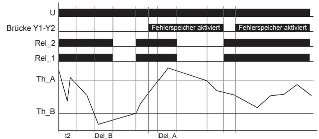
Beispiel: Zurücksetzen des Fehlerspeicher bei Windowfunktion durch Drücken der Plus- Minus-Taste (+ & -)
