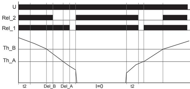
Beispiel: I=0 Inv. mit Minimumüberwachung (2MIN+I=0 ON)
