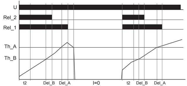
Beispiel: I=0 Inv. mit Maximumüberwachung (2MAX+I=0 ON)
